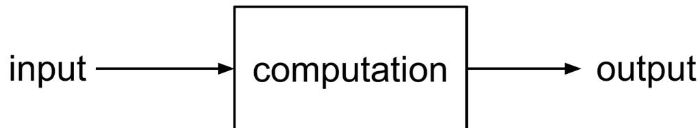
Abbildung 2: Das EVA-Modell besteht aus der Eingabe, der Berechnung und der Ausgabe.
